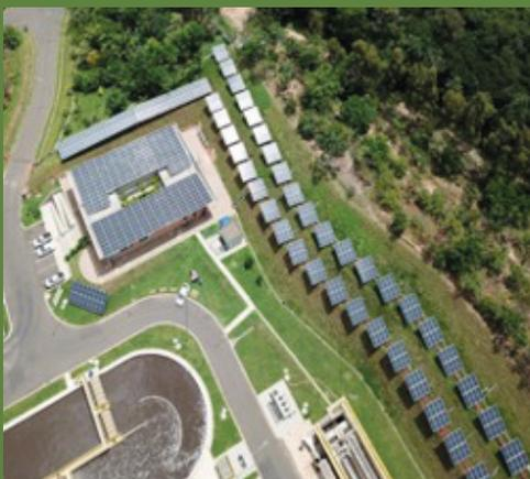
Parte del tratamiento de las aguas residuales de la ETE será realizado a través del uso de energía solar. Para la generación esta energía renovable se cuenta con placas fotovoltaicas con la tecnología PERC (Passivated Emitter and Rear Cell), la cual genera energía de manera más eficiente que otras placas fotovoltaicas.
